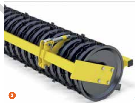
Figuur 1 Twee types van aandrukrollen van het type pakkerwals. 1 smalle schijven, 2 brede schouders. - Bron: Kerner
