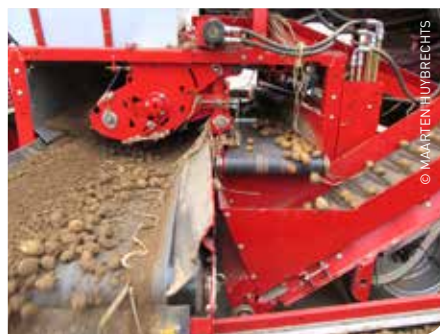
Aardappelen scheiden van de grond gebeurt op basis van het verschil in veerkracht tussen kluit en aardappel. De veerkracht wordt verkregen door de valkracht op een speciale rol.
