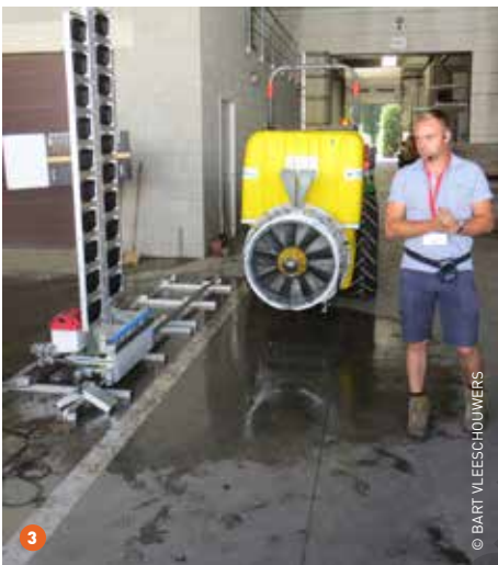
1 Door de grote belangstelling werden de deelnemers in verschillende groepen ingedeeld en rondgeleid. 2 Spuiten met een minimum aan product kan ook met handgedragen apparatuur. 3 Met deze verticale meetwand kan de spreiding van de spuitvloeistof in het gewas gesimuleerd worden om de spuit beter af te stellen. 4 Mechanische onkruidbestrijding is moeilijk als de grond te hard is door droogte.
