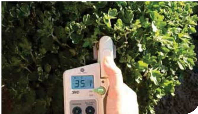
▲ Chlorofylgehalte in het blad wordt gemeten met een SPAD-meter
