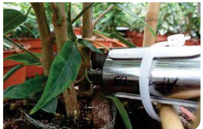
▲ Een LVDT meet continu de zwel en krimp van een Ficus -stengel
