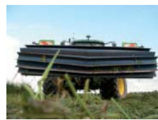
A Harbox-messen De 10 cm hoge messen zijn in een V-vorm of de stalen rol gelast. De messen staan iets voorover
