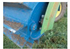
C Water in de rol De stalen rol heeft een inhoud van 565 liter, die je kunt vullen met water. Hoe zwaarder je de machine maakt, hoe beter zij snijdt.
