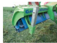
B Steunpoten De machine is voorzien van een steunpoten. Daardoor kun je de machine wegzetten, zonder dat de messen de grond raken.
