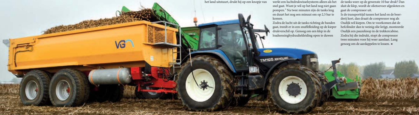
0,7 bar op het land, 2,5 op de weg De Michelin CargoXbib worden gevuld vanuit twee 500 liter tanks op de kieper. De wagen is voorzien van een compressor.
