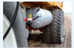
0,7 bar op het land, 2,5 op de weg De Michelin CargoXbib worden gevuld vanuit twee 500 liter tanks op de kieper. De wagen is voorzien van een compressor.
