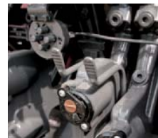
De koppelingen van de dubbelwerkende ventielen zijn met hendeljes op drukloos te zetten. Dat vergemakkelijkt het aanbrengen.
