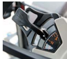
Massey Ferguson gebruikt dit plantere poekje links onder het stuur zowel bij de cvt als bij de powershift.
