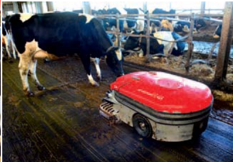
De robot kan zowel op een geprofileerde betonvloer als op een rubber beklede vloer uit de voeten. Een helling van 3 procent kan de mestrobot niet aan.
