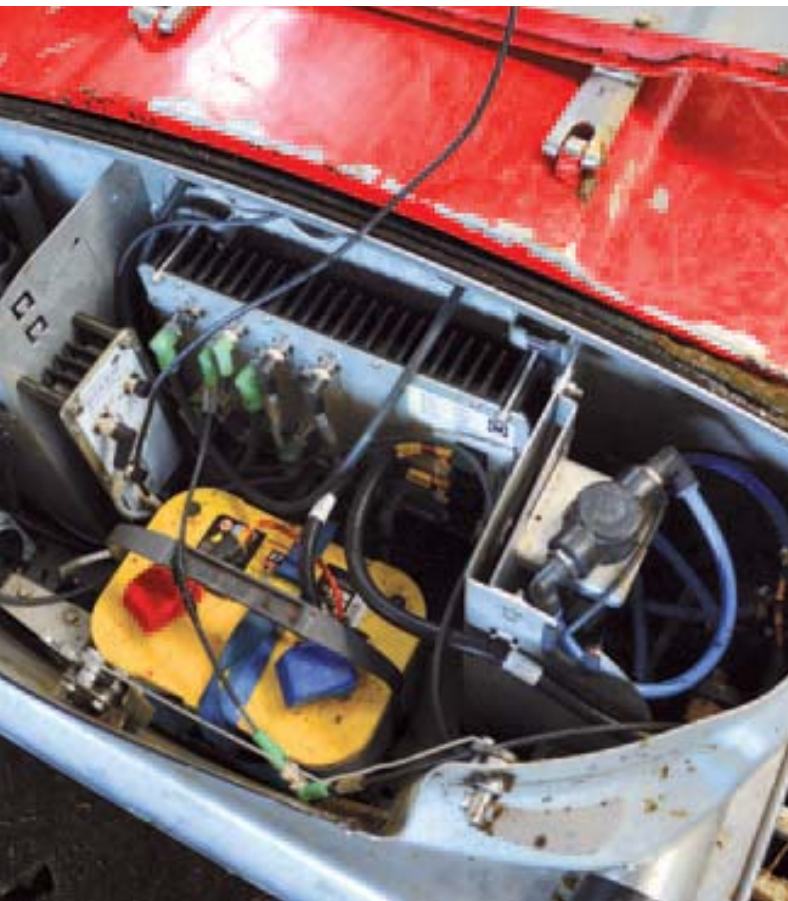
Aan de voorkant van de machine is alle techniek te vinden. Van links naar rechts: de vacuumpomp, de accu en printplaat, de waterpomp.
