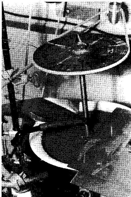
Afb. 2 - Detailopname van het vitale gedeelte van de indampapparatuur. De bovenste schijf wordt aangedreven door een roermotor via verschillende 'vertragingen'. De schijf is voorzien van een schaalverdeling voor het bepalen van de omwentelingssnelheid. De onderste schijf is de indampschijf van pijp-aarde. Duidelijk zijn te onderscheiden, de schraper (links), de beide 'elektroden' van de hoogfrequent-generator (rechts) en de toevoerslang van het slib (midden). Links onder: bovenkant van de voorraadflës.
