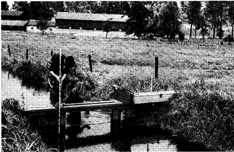
Het opmeten van de overstorthoogte (meetpunt 34).
