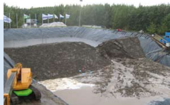
De full-scale dijk wordt onder meer gebruikt voor het testen van nieuwe monitoring- en inspectietechnieken
