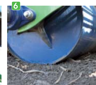
[3] De voorste dieptewielen lopen nu nog over het bed. De Nieuwstad overweegt de wielen achter het trekkerwiel te monteren.
