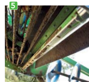
[2] De schijven hoeven maar 1,5 tot 2 cm door de grond te lopen. De draaiende schijven wrijven de uien uit de rij in het zwad.
