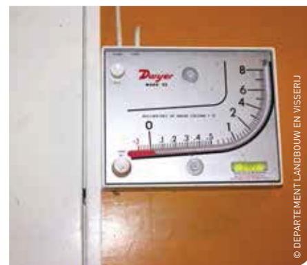
Onderdrukmeter (of drukverschilmeter). Er is een zeer kleine onderdruk van 0,02 mm water kolom of 0,2 Pa.
