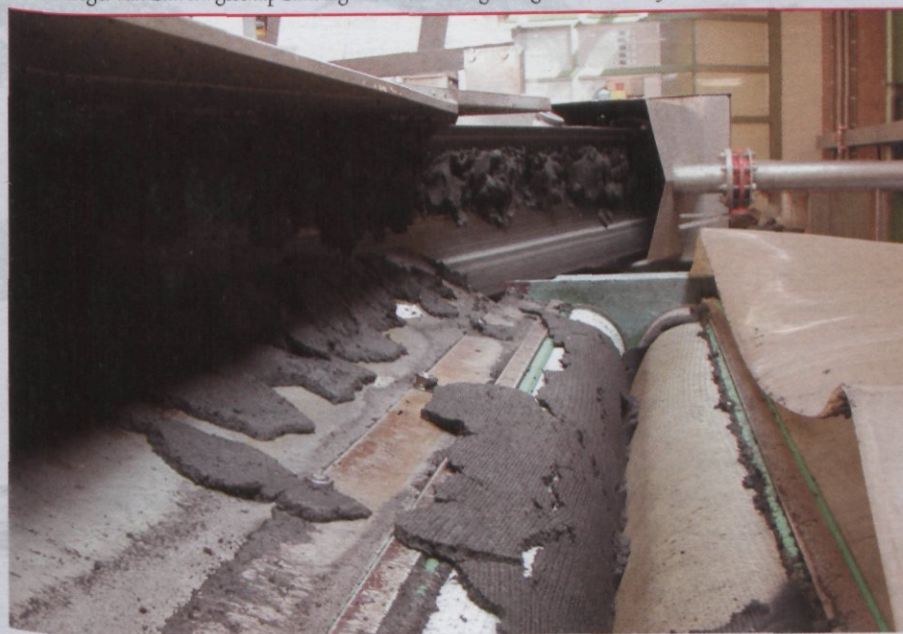
De slibdroger van Zuiveringsschap Limburg in Susteren. Het gedroogde slib wordt bij ENCI verwerkt in cement.
