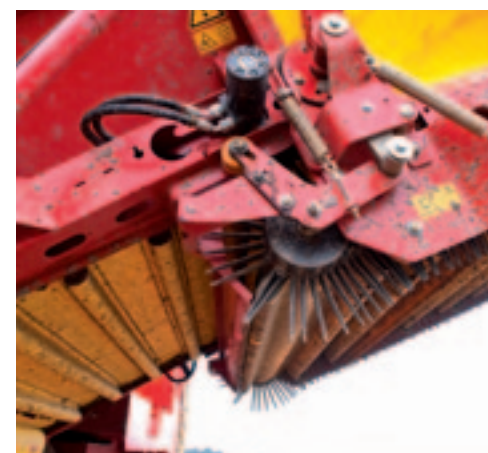
^ Morsen De bunker met een bodem- en een bunker-mat lost niet snel en morst. Inmiddels heeft Grimme de bunker aangepast.
