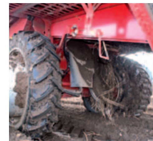
^ Mat op stuur Bij de stuur is een grote rubberen mat gemonteerd die voorkomt dat zich daarop loof en grond ophoopt. Dit werkt goed.
