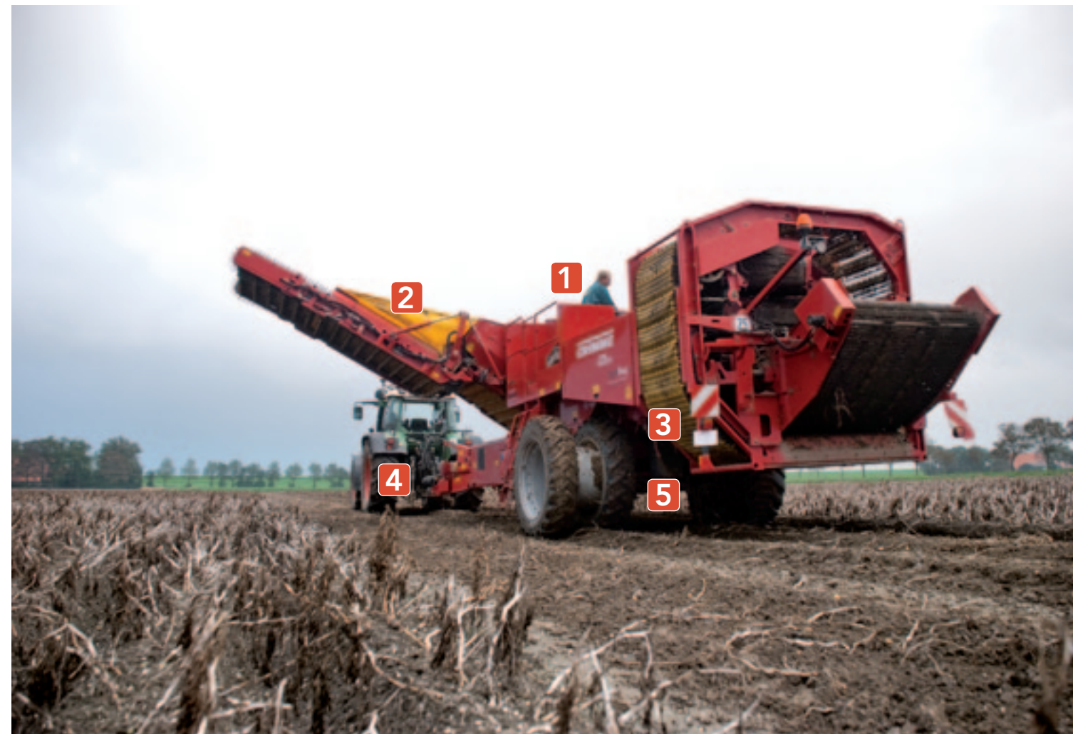
^ Grimme SV260-verstekrooier De leestafel [1] is breed en biedt ruimte aan vier mensen. Over de bunker [2] waren we minder tevreden. Inmiddels heeft Grimme de constructie ervan aangepast. De 90 cm brede ringelevator [3] heeft zogenoemde OptiBags, zakken van geperforeerd kunststof. Grimme meent dat een trekker van 90 kW de rooier aan moet kunnen. Maar deze trekker [4] van 110 kW heeft zijn handen er vol aan. Wiel aandrijving [5] kost dik 30.000 euro.
