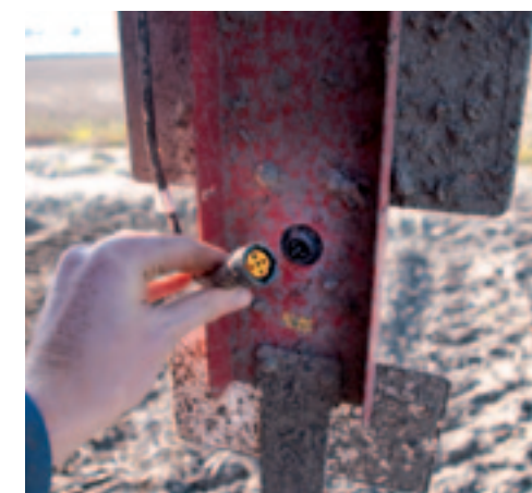
^ Canbus, tot aan de lampen De machine beschikt over veel elektronica. Zelfs de verlichting wordt via canbus aangesloten.
