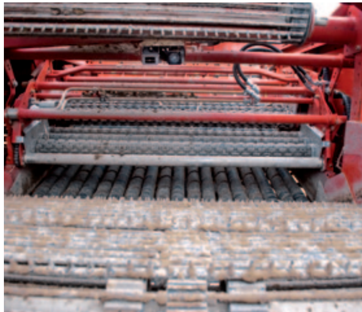
^ Axiaalreiniging De axiaalreiniger heeft negen gladde en negen rollen met een spoed die samen een stel vormen. De openingen tussen de rollen zijn vanuit de cabine traploos te vergroten of te verkleinen.
