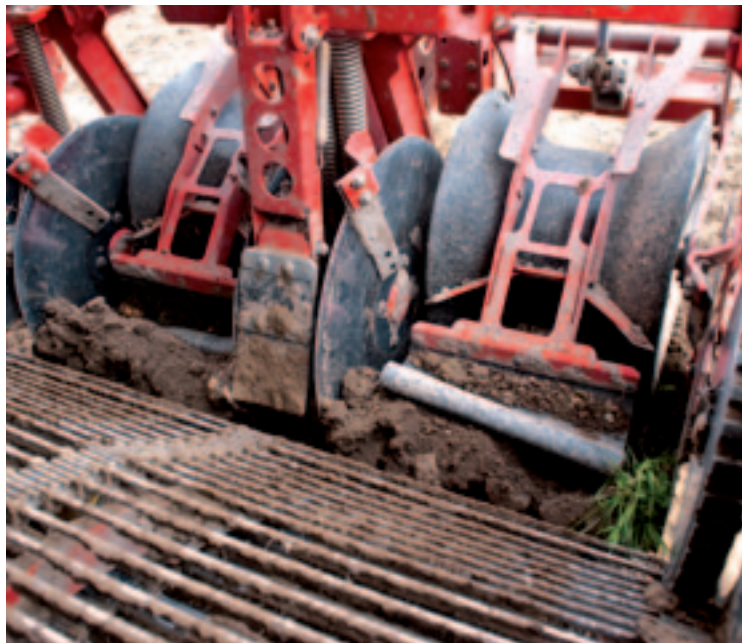
^ Extra flap De tweedelige rooischaar heeft een extra rubberen flap die voorkomt dat de aardappelen uit de machine rollen als je de rooibek heft. De kunststof diabolrollen hebben een doorsnede van 39 cm.
