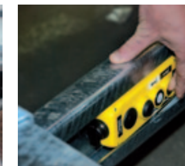
Een elektrische kiepfunctie werkt sneller, maar is storingsgevoelig. Een lege accu betekent niet kiepen.
