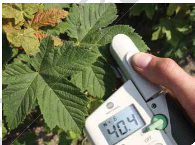
▲ Chlorofylmeting als indicator voor de N-status van de plant
