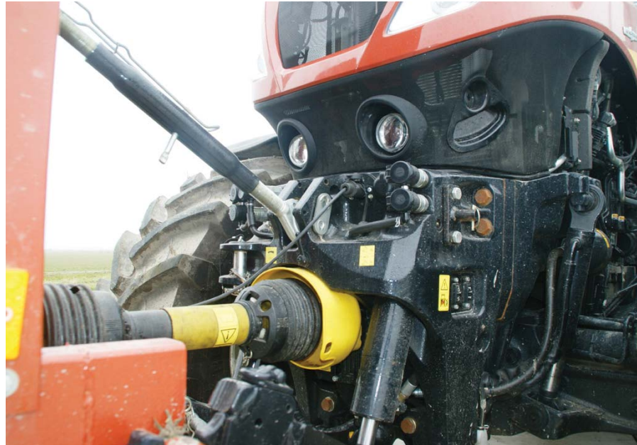
Belangrijke vernieuwingen zijn deze nieuwe fronthef- en aftakasunit met spaaftakas en de nieuwe voorasvering met langere draagarmen en dubbele cilinders.
