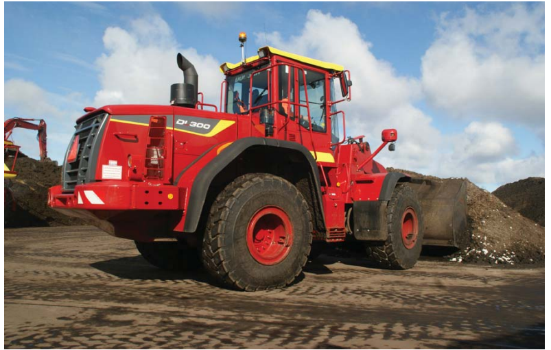
Muntjewerf heeft deze nieuwe negentientons Doosan DL 300 met Scania-Stage IV-vijfcilindermotor en vijfkuubs AA-volumebak draaien. Volgens Muntjewerf met een prima prijs-kwaliteitsverhouding.
