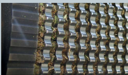
Het stro wordt tussen twee matrijzen doorgeperst en via de gaten tot pellets gevormd.
