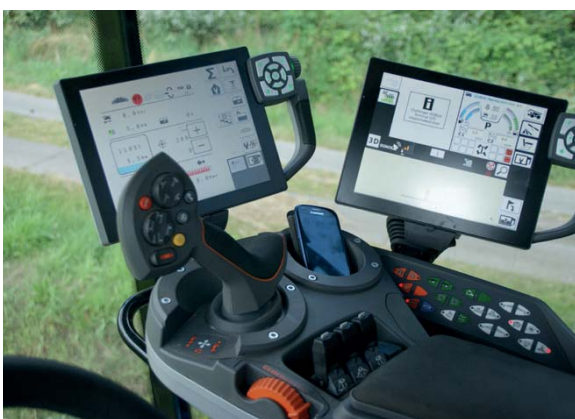
De bediening is ook gewijzigd, zoals de armleuning met de nieuwe rijhendel en een veel kleinere stuurconsole. In de rechter voorstijl ontbreken de meters.
