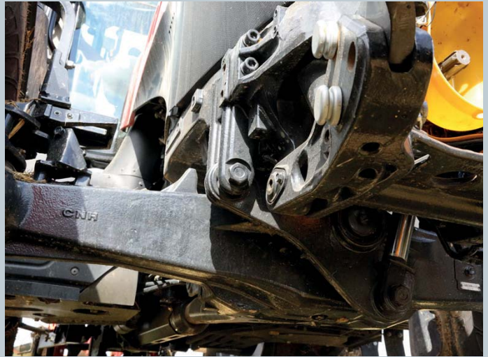
Case IH ontwikkelde zelf de vooras, inclusief vering, en de geïntegreerde frontaftakas. De vering is instelbaar, met een veerweg van acht centimeter.
