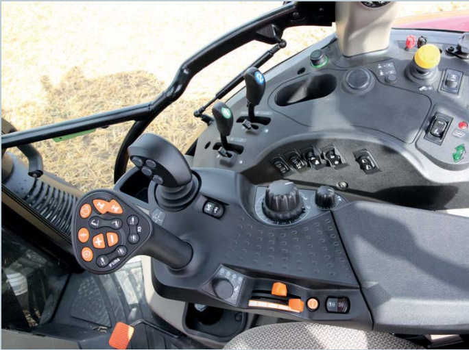
De Luxum heeft een opklapbare armleuning, met links de multihendel en rechts de joystick voor het bedienen van frontlader of fronthef en elektrische ventielen.
