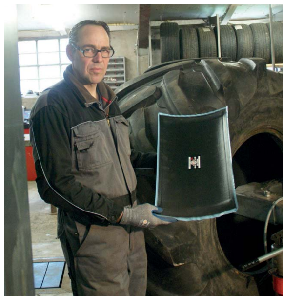
Johan Lagerweij wijst ook op de juiste keuzes van de pleisters. "Daar zijn tabellen voor. Met pleisters als deze zijn flinke beschadigingen te repareren, mits je goed en nauwkeurig werkt."
