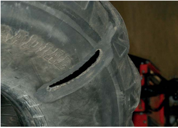
Scheuren als deze zijn te repareren, mits rubber en koordlagen in orde zijn. Na oververhitting is een band niet te repareren, omdat het rubber dan van samenstelling is veranderd.
