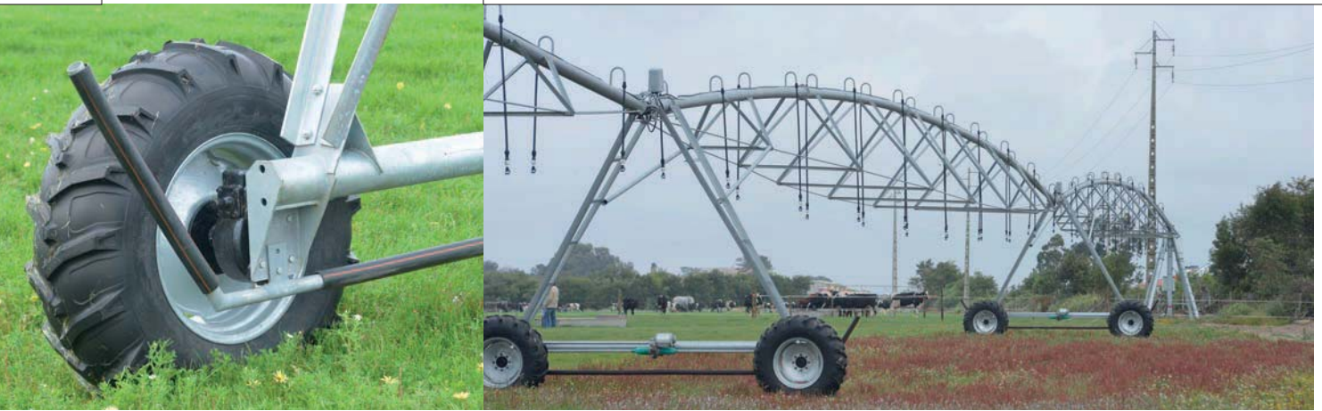
Links: via een speciale constructie kan de pivotberegening gewoon over de flexibele afrastering heen rijden. Rechts: 100 hectare weiland kan in de zomer twee tot drie keer per week worden beregend
