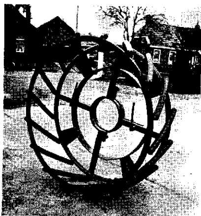
Afb. 30 Modern kooiwiël met snelsluiting voor trekkers met lange assen. De ribben verlopen schuin en zijn gebogen om een stotende gang te voorkomen
