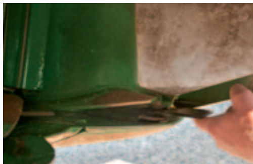
Met het bijgeleverde gereedschap, een hefboom, zijn de mesjes eenvoudig te verwisselen.
