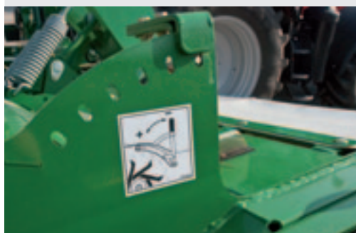
Voor een agressiever kneusresultaat, kun je de kneusplaat dichter op de rotor zetten.
