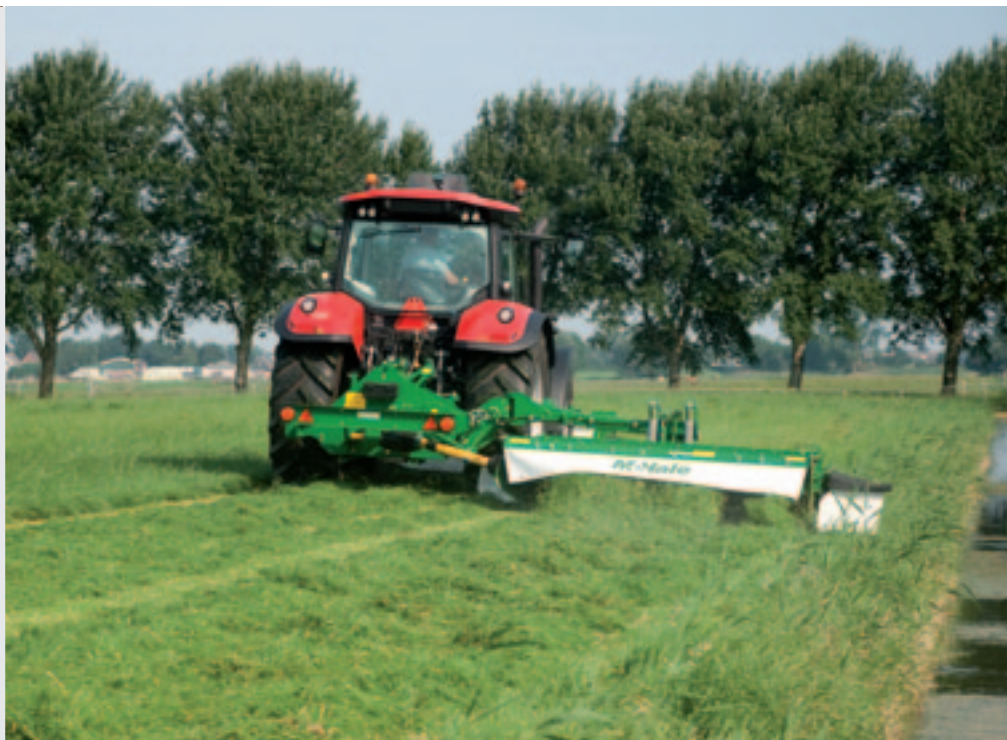
De McHale-maaiers leggen het gras iets smaller weg dan de werkbreedte. Dat komt doordat de kneuzer een fractie smaller is dan de maai balk.
