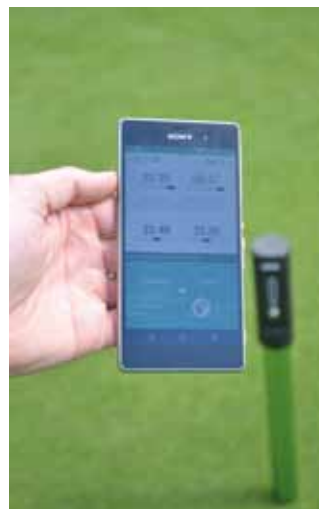
De Pogo is een draagbare bodemsensor die met smartphone uit te lezen is.
