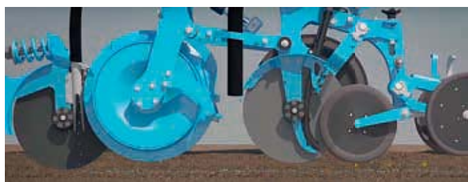
Figuur 1 Eén zaai-element bestaat uit 8 bemestingselementen en 2 x 8 zaaielementen om 16 rijen maïs te zaaien - Bron: Lemken
