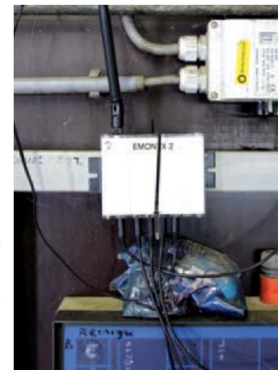
Alle apparatuur om het energieverbruik te meten is begin deze zomer bij Alfons Breij geïnstalleerd. Dit kastje verzamelt alle gegevens.
