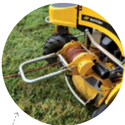
De aandrijving van de lier en de wielaandrijving zijn op elkaar afgestemd.
