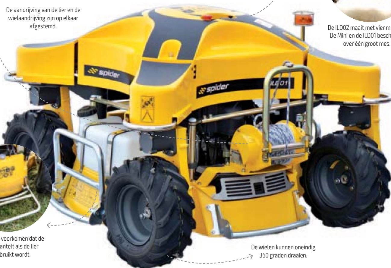
Via de afstandsbediening kunnen tien functies aangestuurd worden.
