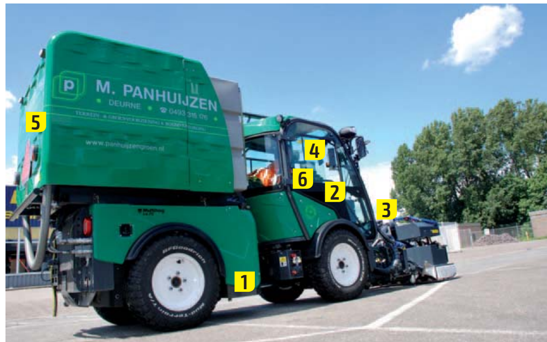
Voor onderhoud kunnen beide zijkanten en de achterkant uitgeklaapt worden. Mocht er iets zijn onder de cabine, dan kan die in haar geheel naar voren gekanteld worden.
