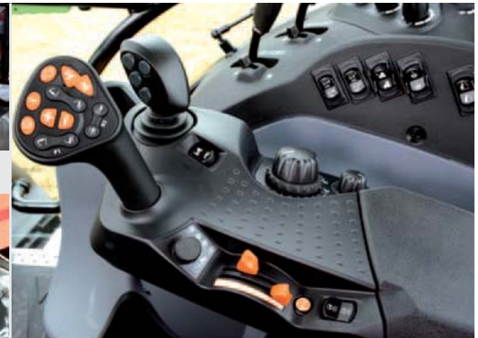
De rechterarMLEuning herbergt de Multicontroller waarmee je de transmissie, maar ook de hef en de hydraulische ventielen bedient. Je kunt de leuning opklappen. Je kunt dan ook via de rechterdeur uitstappen.
