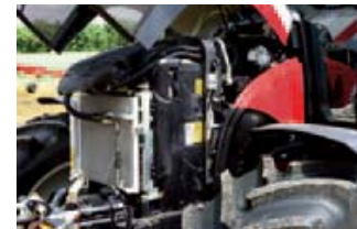
De Multi heeft een viercilinder met een inhoud van 3,4 liter. Er moet wel AdBlue in.
