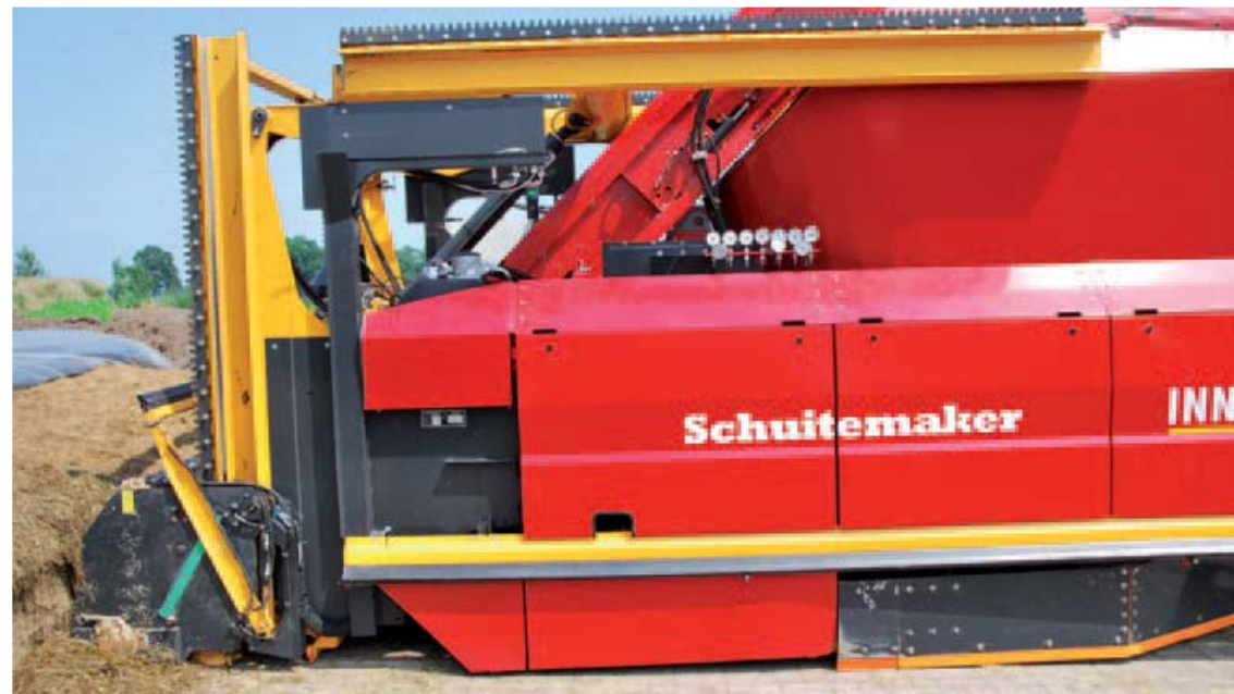
Om voer uit te halen gaat de Innovado hydraulisch door zijn knieën. Het vorkenbord komt onder het voer, zoals dat bij een U-snijder ook gaat. Over het gele, hier ingeklapte, frame, kan het snijraam omhoog tot 4,5 meter. Een vijzel boven het vorkenbord werkt het losgesneden voer op een opvoerband.
