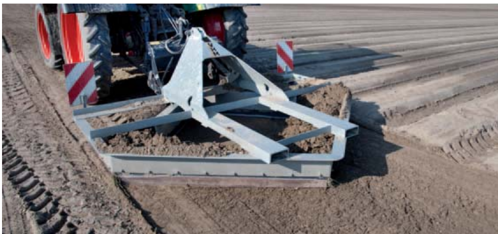
▲ Scrapr De Scrapr is een machine met twee driehoekige Hardox-messen. Je kunt de machine hydraulisch in alle richtingen verstellen.
