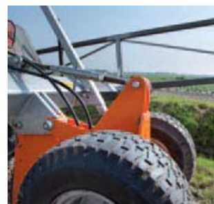
▲ Dieptewielen Met een topstang stel je de dieptewielen af. Advies is om de buizen op een diepte van circa 40 cm te leggen.
