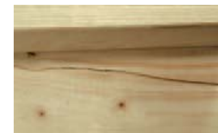
^ Scheuren en kwasten Veel kwasten (noesten) en scheuren in het constructiehout, maken het minder sterk. Een kopscheur mag maximaal 10 cm lang zijn.
