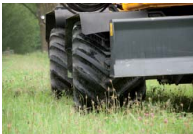
De vierwielbesturing (met hondengang) vindt Beverloo heel handig. Zo kan hij altijd van een object of watergang af sturen en hij kan de machine makkelijk tussen objecten zetten.
