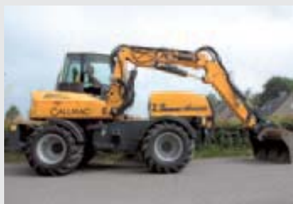
Met de Gallmac kan Beverloo de openbare weg op zonder verkeersregels te schenden, ook met een maaikorf van 4,3 meter is het verste punt niet meer dan 3,5 meter van de stuurkolom af en de transporthoogte blijft onder de vier meter. De gieken, ook de korte, reiken rondom de machine over de onderwagen.
