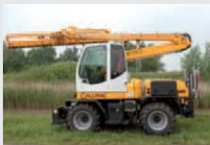
Met de Gallmac kan Beverloo de openbare weg op zonder verkeersregels te schenden, ook met een maaikorf van 4,3 meter is het verste punt niet meer dan 3,5 meter van de stuurkolom af en de transporthoogte blijft onder de vier meter. De gieken, ook de korte, reiken rondom de machine over de onderwagen.
