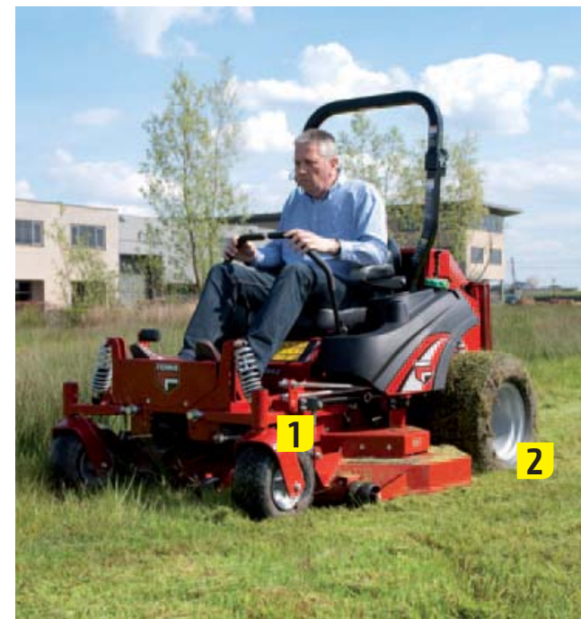
Spindels maken het instellen van de ophanghoogte van het maaidek ten opzichte van het centrale frame makkelijker.
