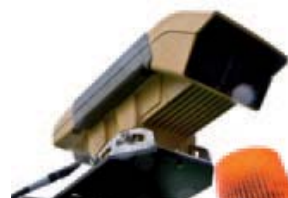
▲ Topcon-lasersensoren Twee lasersensoren van Topcon die op het cabinedak zijn gemonteerd 'bekijken' de gewaskleur over de gehele werkbreedte.
