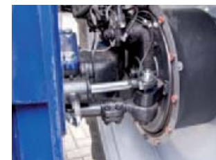
▲ Fuseebesturing De machine is voorzien van fuseebesturing via een gyroscop. Boven 10 km/h wordt de besturing uitgeschakeld.
