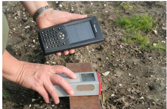
Afbeelding 8: Met een optisch afstandsmeter werden de afstanden gemeten van de basislijn tot het bordje in het markeurspoor. De waarnemingen werden meteen in een veld computer ingevoerd.
