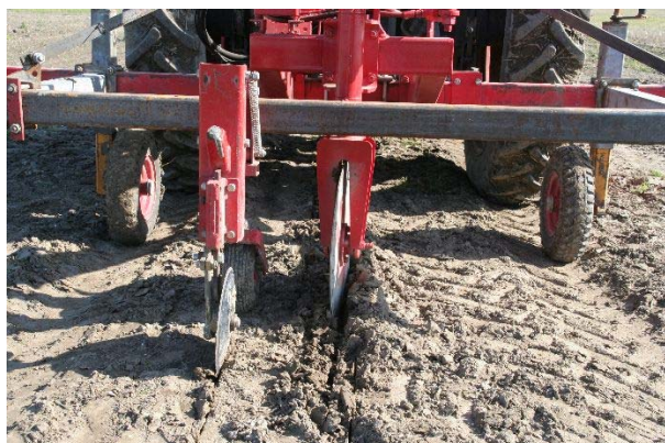
Afbeelding 2: Stuursysteem "stuurschijf" met schijfmarkeur.
