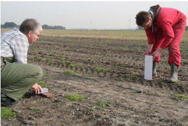
Afbeelding 7: Een nylon draad vlak boven de grond gaf de positie van de basislijn weer. Een kunststof bordje werd in het spoor van de markeurschijf geplaatst.
