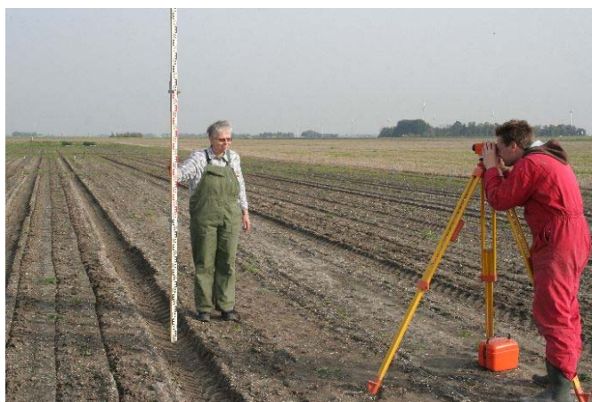
Afbeelding 6: Met een waterpastoestel werd elke meter de hoogte van de wielspooren gemeten.
