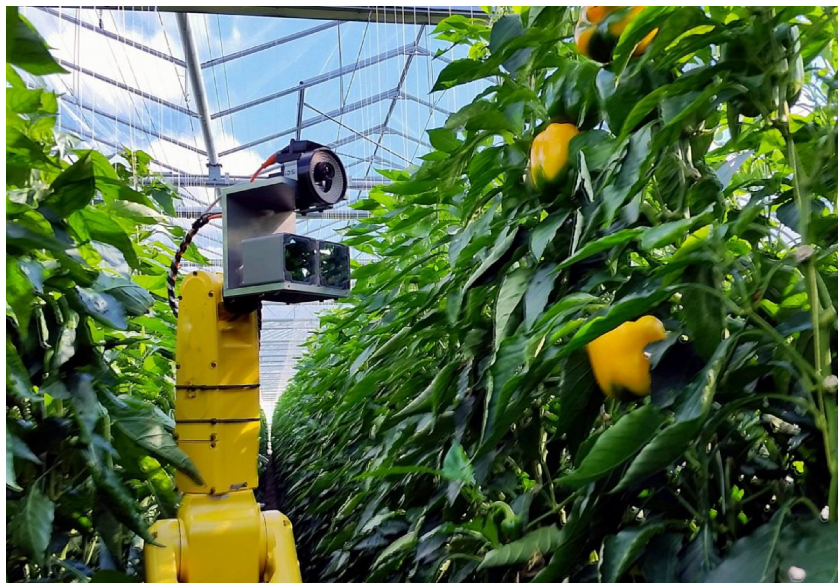
Figuur 3. De eerste acties van de SWEEPER robot bij het testen van het camera systeem in het eerste jaar van het onderzoek in de kas van de Tuindershoek.
