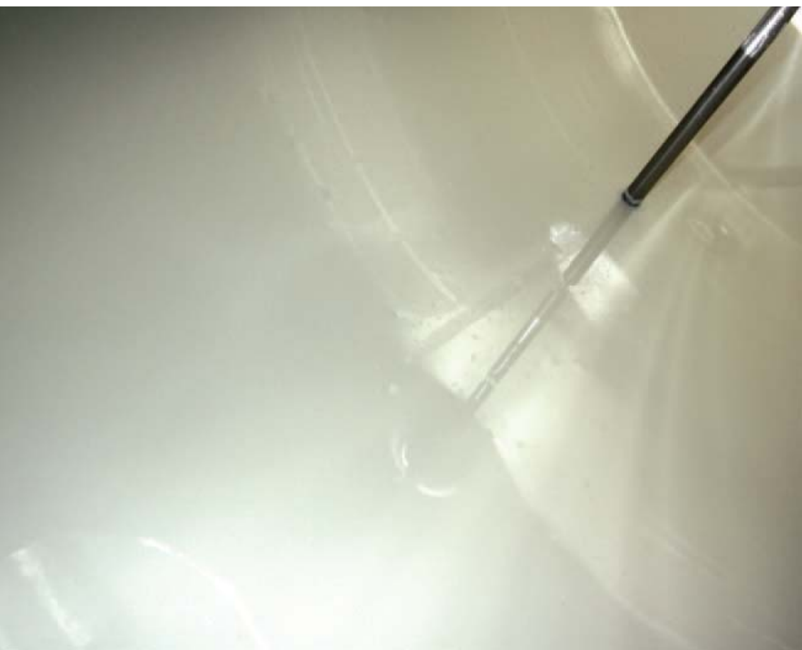
< De Agricool-warmtewisselaar bevat een spiraalvormige buis waar water en melk in tegengestelde richting doorheen lopen.
