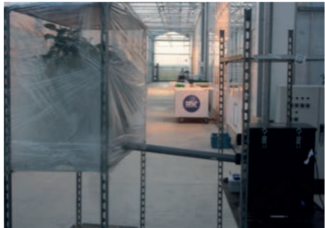
Figuur 2.10 Links de paprikaplanten in de geconditioneerde kas, rechts de opstelling met het fogapparaat (rechts onder) van B&B humidifications.
