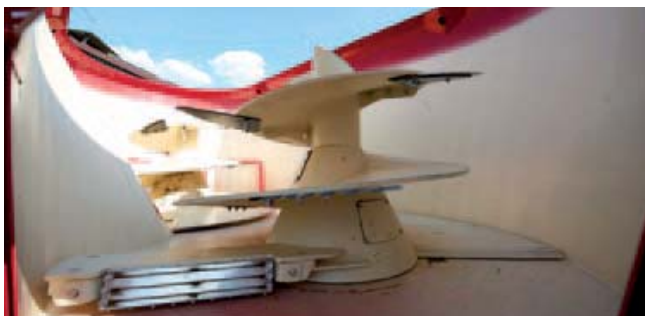
Door de hoek van de snijmesses aan te passen is de mengintensiteit regelbaar.
