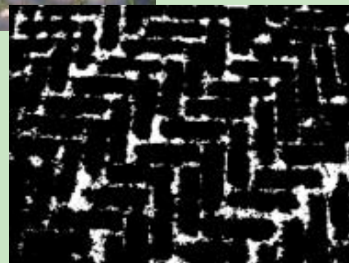
Beeldanalyse voor bepaling onkruidbedekking (14% in dit geval).
