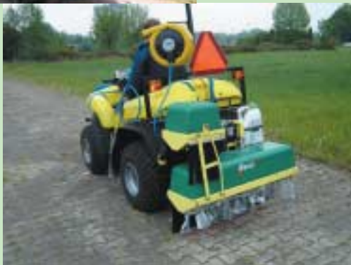
Voorbeelden van twee innovatieve methoden onkruidbestrijding verhardingen (WAVE, selectieve heetwatermethode en Weed IT, selectieve chemische methode).
