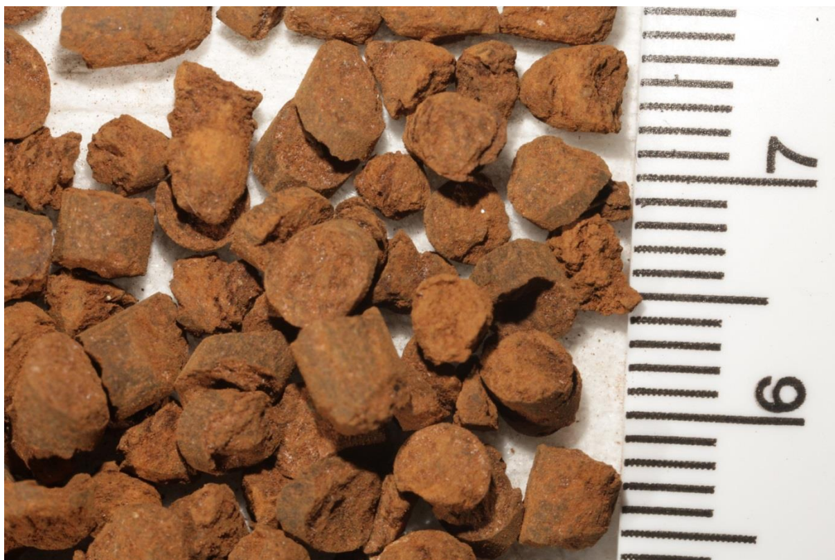
Afbeelding 3. Op ijzeroxide gebaseerde pellets voor de adsorptie van fosfaat en arseen, die worden ontwikkeld bij KWR Watercycle Research Institute
