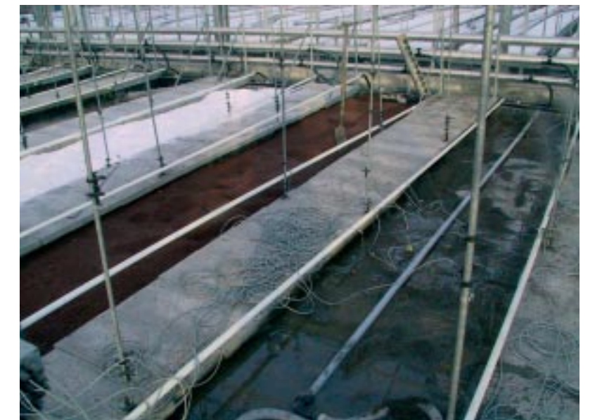
Proefopstelling met 3 substraten Links: Flugzand wordt onder water gezet door buis met gaatjes
