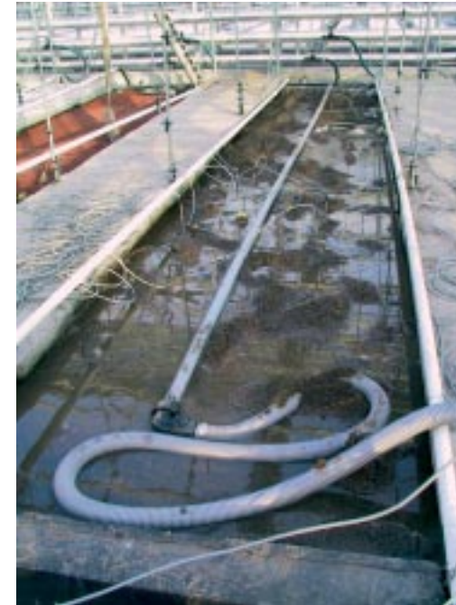
Proefopstelling met 3 substraten Links: Flugzand wordt onder water gezet door buis met gaatjes
