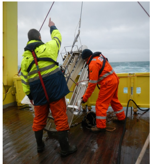
Overboord zetten van de planktontorpedo aan boord van de Zirfaea (foto Dirk Burggraaf)
