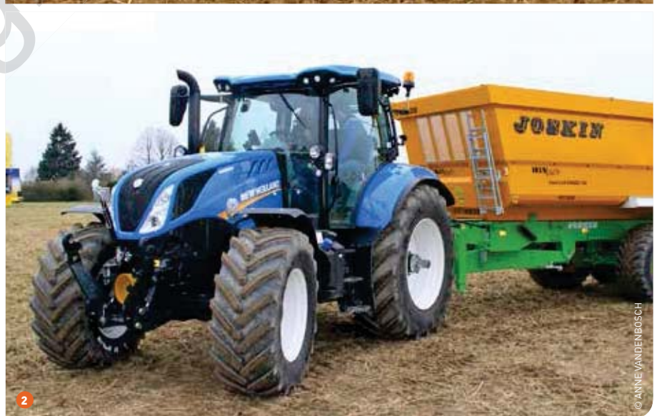
1 De styling van de nieuwe T5 werd afgestemd op deze van de grotere broertjes T6 en T7. 2 De nieuwe T6-serie biedt een grote keuze, met 5 viercilindermodellen met vermogens uiteenlopend van 125 tot 175 pk. Het topmodel, de T6.180 met 6 cilinders, beschikt over een maximumkoppel van 740 Nm. Hier zie je de T6.175 Auto Command aan het werk.
