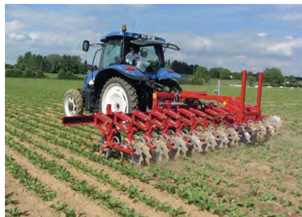
Cameragestuurde schoffelmachines kunnen bij een hoge rijnsnelheid dicht op de rij werken.
